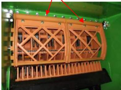
Zerkleinerungsklappe wird nach folgenden Schritten gewechselt:
