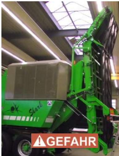
Um die Zerkleinerungsklappe zu wechseln, muß das Austragsband in die Wartungsstellung gebracht werden. Eingewiesene Person muß im Gefahrenbereich arbeiten. Dabei ohne Bandzylindersicherung entsteht tödliche Gefahr für menschliches Leben.
