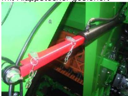
8. U-Profil (Stütze) **beidseitig** über Kolbenstange von Hydraulikzylinder anbringen und mit Bolzen und Klappstecker sichern.
