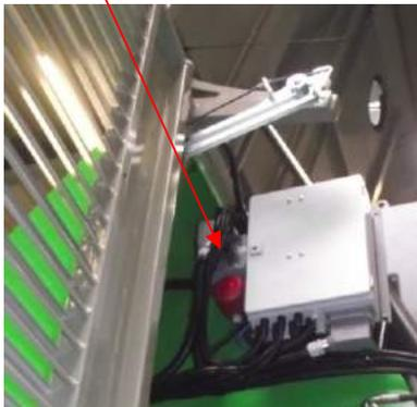
An der Maschine ist eine Sirene angebracht. Die Sirene befindet sich an der linken Seite in die Fahrtrichtung der Maschine neben dem Motorsteuerkasten. Wird ein Befehl von Schaltschrank oder Funkfernsteuerung für Funktionen bewirkt, schaltet sich die Sirene ein.
