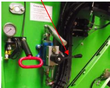
Der Bolzen ist noch nicht in die Haubesicherung eingerastet.
