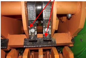
Abbildung 7.18 Freier Durchlauf der Schlegel prüfen
