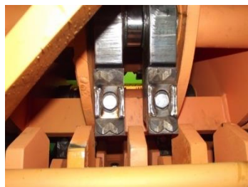
Abbildung 7.18 Freier Durchlauf der Schlegel prüfen
