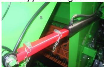
8. Das U-Profil (Stütze) **beidseitig** über die Kolbenstange von Hydraulikzylinder anbringen und mit Bolzen und Klappstecker sichern.
