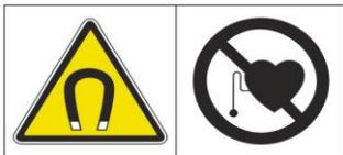
Dieses Warnschild befindet sich beidseitig an der Maschine, wenn die Maschine mit Metallabscheider ausgerüstet ist.
