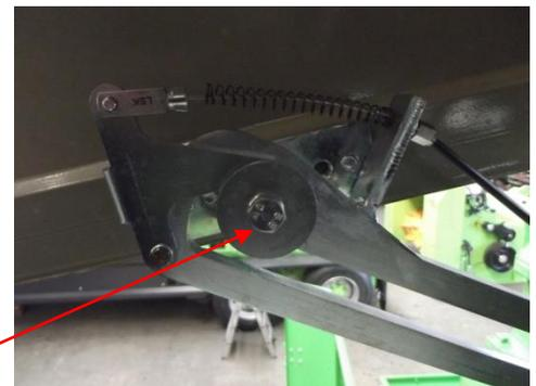
Der Bolzen ist in die Haubensicherung eingerastet.
