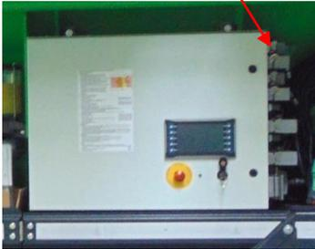
An der Maschine ist eine Sirene angebracht. Die Sirene befindet sich an der linken Seite in die Fahrtrichtung der Maschine neben dem Motorsteuerkasten. Wird ein Befehl von Schaltschrank oder Funkfernsteuerung für Funktionen bewirkt, schaltet sich die Sirene ein.
