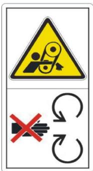
Bei der Einstellung des Winkelsensors für den Probelauf muss der Keilriemenschutz geöffnet sein. **Achtung!** Dadurch besteht Gefährdung für Personen durch rotierende Spannrolle und Powerbänder besteht.
