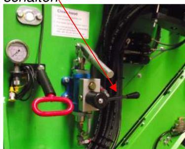
2. Roten Hebel ziehen und gleichzeitig Ventilhebel nach rechts schalten.
