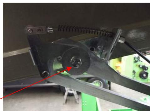
Der Bolzen ist in die Haubesicherung eingerastet.
