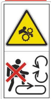
**Einzugsgefahr durch beweglichen Rollboden und rotierende Einzugswalze**
