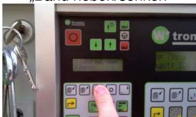
2. Funktion Band heben / senken wählen, Band heben;
