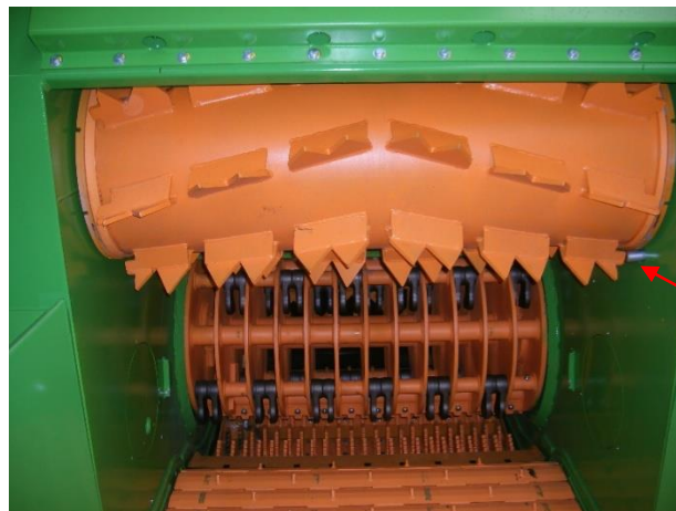
Rodillo de alimentación se desplazó hacia arriba y se fijó con bulones
