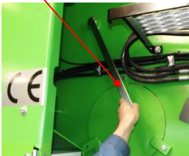
Rodillo de alimentación se desplazó hacia arriba y se fijó con bulones
