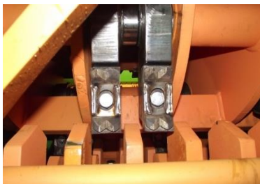
Figura 7.18 Controlar el giro libre de las cuchillas
