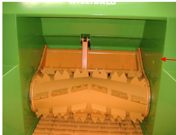
Rodillo de alimentación abajo sin bulón
