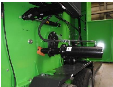
Figura 7.13 Desplegar el dispositivo hidráulico
