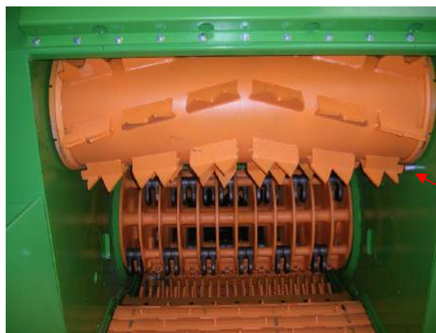
Rodillo de alimentación se desplazó hacia arriba y se fijó con bulones
