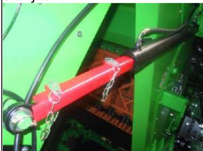
8. Colocar perfil en U (soporte) **bilateralmente** a través del vástago de pistón del cilindro hidráulico y asegurar con bulones y pasares clavijas.
