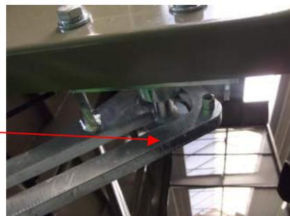
5. Conmutar la palanca de válvula hacia la derecha
