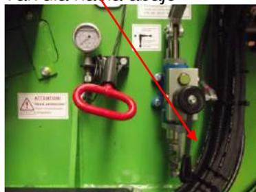
Conmutar la palanca de válvula hacia la derecha
