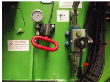
La palanca de válvula indica hacia abajo
