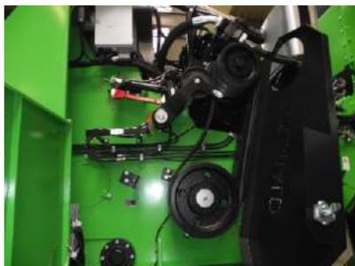
El cilindro hidráulico debe estar introducido. En el armario de distribución se emite el mensaje "Embrague desacoplado".
