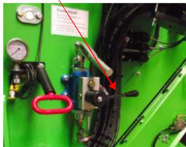
2. Tirar la palanca roja y mover la palanca de válvula simultáneamente hacia la derecha.
