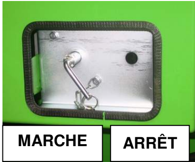
Interrupteur principal de la batterie
