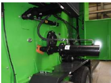
Illustration 7.13 Sortir l'extracteur d'arbre
