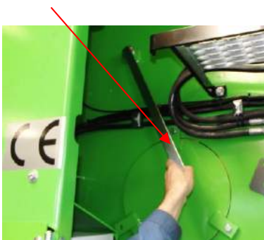
Rouleau d'alimentation relevé et freiné par des axes
