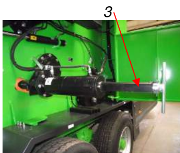
Illustration 7.15 Mise en place de l'entretoise
