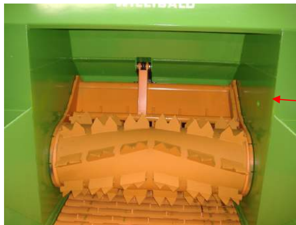
Rouleau d'alimentation sans axe dans la partie inférieure
