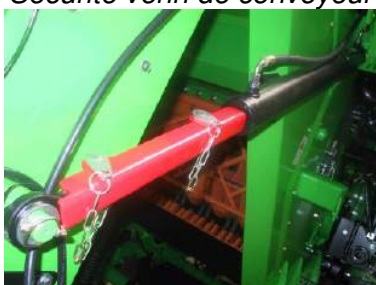
Illustration 7.13 Sortir l'extracteur d'arbre
