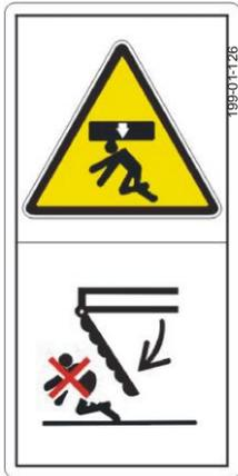
**Risque d'écrasement au niveau du convoyeur de sortie.**
