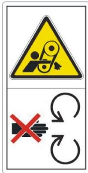
**Risques de happement et d'écrasement dus à la rotation du galet tendeur et à la courroie d'entraînement°!**
