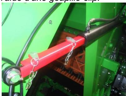
8. Mettre le profilé en U (appui) en place des deux côtés du vérin hydraulique et le freiner avec un axe et une goupille-clip.
