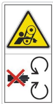
Lors du réglage du capteur d'angle pour la marche d'essai, la protection de la courroie trapézoïdale doit être ouverte. Avertir ! Cela constitue une menace pour le personnel, à cause du galet tendeur et des courroies d'entraînement en rotation.
