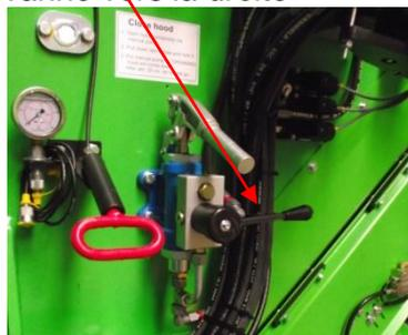
2. Tirer sur le levier rouge et enclencher simultanément le levier de vanne vers la droite.
