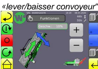
2. Sélectionner la fonction lever/baisser convoyeur et lever le convoyeur.
