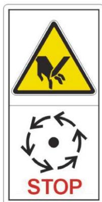
**DANGER****Risques de happement et d'écrasement dus à la rotation du galet tendeur et à la courroie d'entraînement°!**
