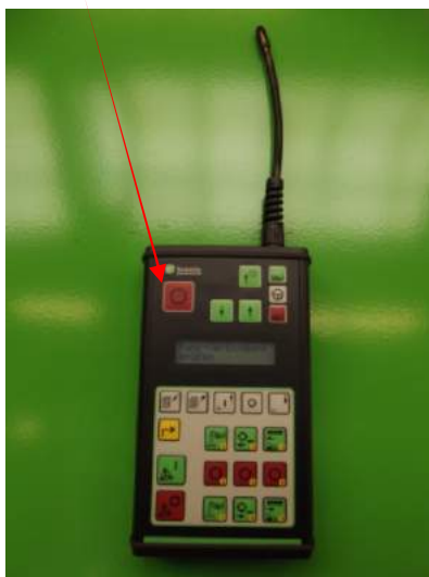
Bouton d'arrêt d'urgence sur la télécommande radio
