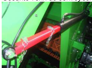
Illustration 7.13 Sortir l'extracteur d'arbre
