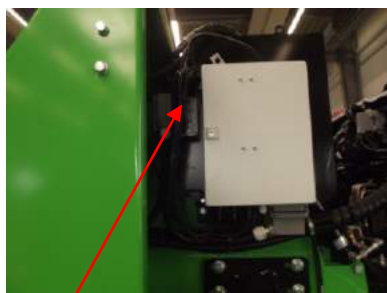
Sirène est installée dans le boîtier de commande du moteur
