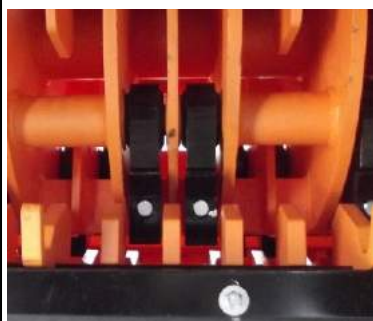
Illustration 7.18 Vérifier la bonne mobilité des fléaux
