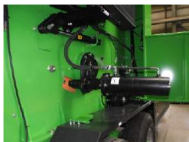
Illustration 7.13 Sortir l'extracteur d'arbre
